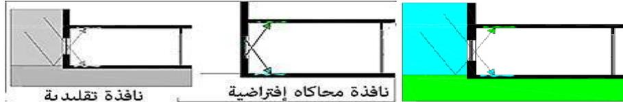
الشكل (21) يوضح نافذة تقليدية ونافذة إفتراضية والتي تعمل علي محاكاة ضوء النهار بحيث تقوم بعكس الضوء "الأرض" إلى السقف وضوء "السماء" إلى الأرض (م 30، ص 17)
